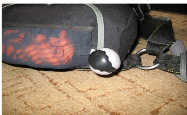
Уложите камеру (стропами вниз) в контейнер основного парашюта. Убедитесь в том, что углы хорошо заполнены. С этого этапа производите укладку в соответствии с системой раскрытия основного парашюта. Порядок зачековки клапанов ранца: **нижний ,верхний, левый, правый**
