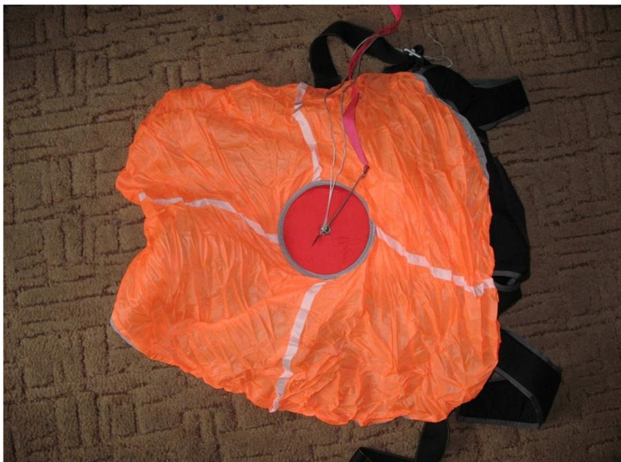
Уложите и распределите ткань вытяжного парашюта так, чтобы она не зажималась между клапанами и нижней частью пружины.
