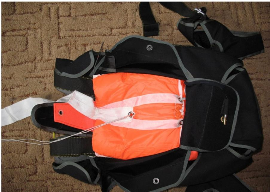
Уложите стренгу в виде V на клапане , чтобы равномерно ее распределить.
